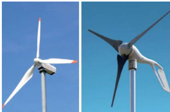
Rysunek 17 Turbiny o poziomej osi obrotu 140
